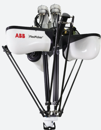
IRB 365 FlexPicker® 五轴并联机器人, 助力轻型产品的快速拾取
